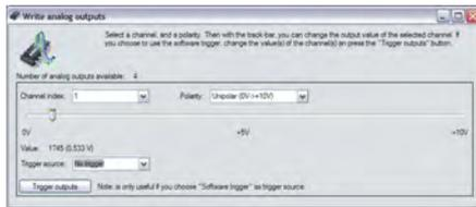
Exemple de la fonction de visualisation: Test des sorties analogiques – Sortie de valeurs sans programmation
